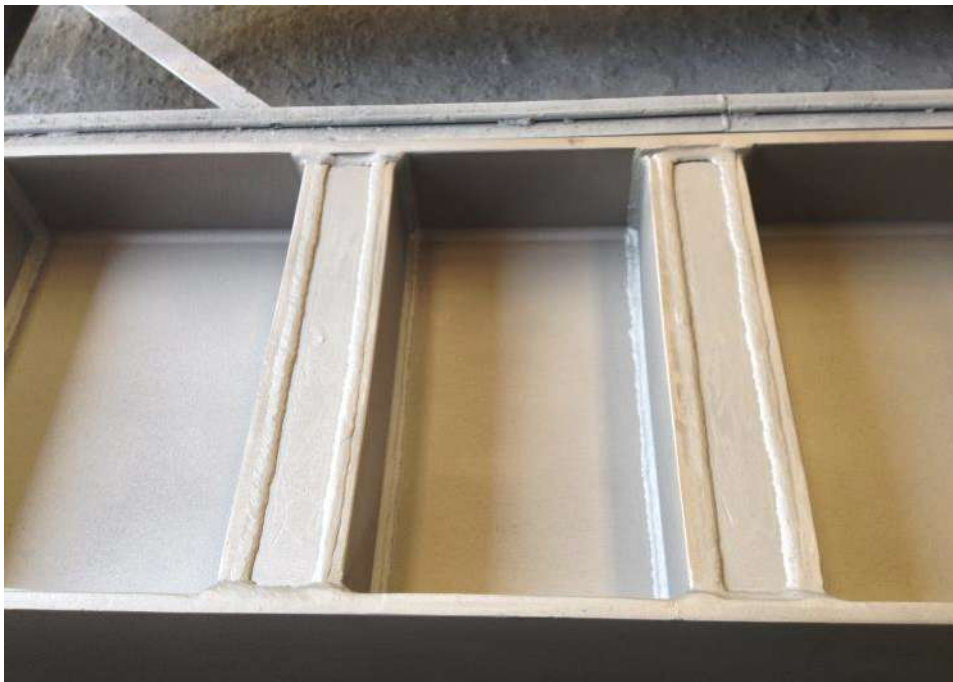
Detalhe dos componentes após ato abrasivo padrão SA 2½
