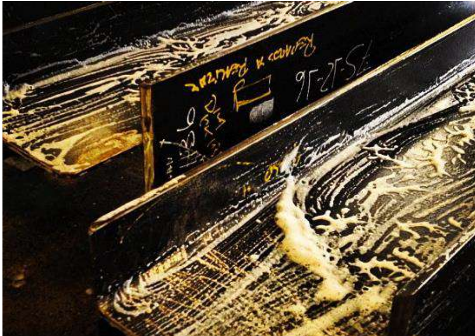
Limpeza com detergente para retirada de contaminantes
